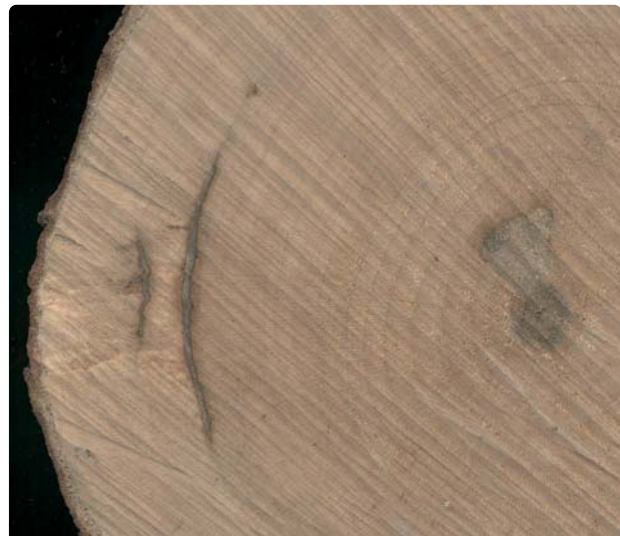
|| Zabitki na klonie; obszar zniekształconej struktury drewna powodowanej ich obecnością nazywany był „drewnem zbolełym”
