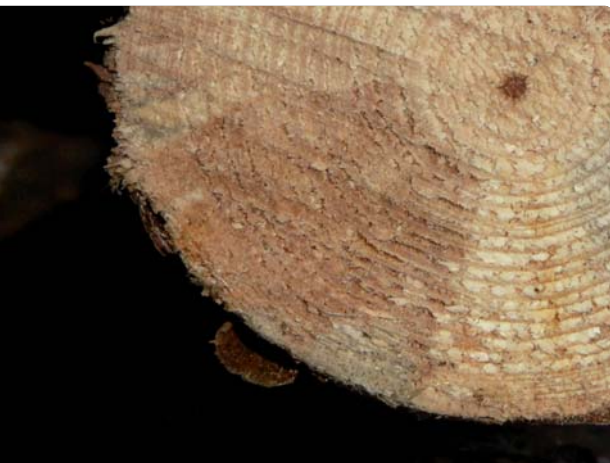
|| Fragment czola drewna sosnowego obarczonego brunatnicą, czyli tzw. drewno czekoladowe
