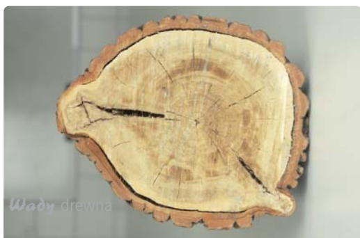
|| Przekrój poprzeczny przez pęknięcia mrozowe na topoli
